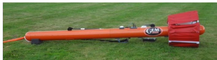
GEM GSMP-35A (Magnetometro) GEM GSMP-35GA (Gradiometro) GEM GSMP-35GA3 (Sistema triassiale con 3 o 4 sensori) (Disponibile con VLF)
