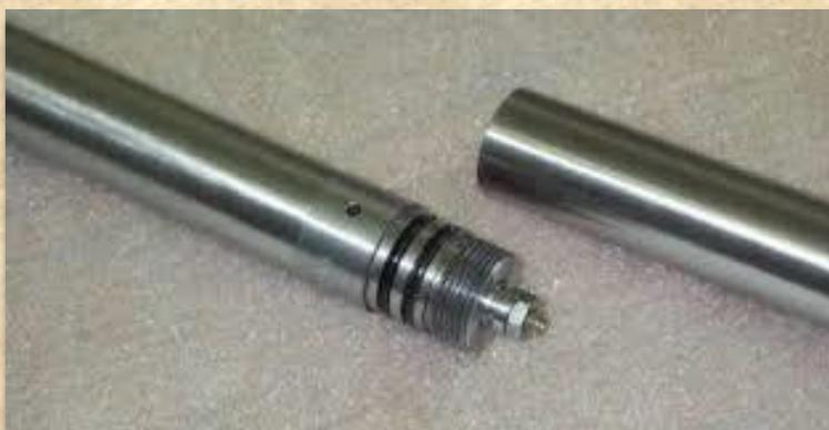
Questa sonda è costituita da un campionatore di fluidi della capienza massima di 1 litro; si cala il campionatore alla profondità voluta ed attraverso l'interfaccia di acquisizione è possibile aprire la camera per il prelievo in situ.
