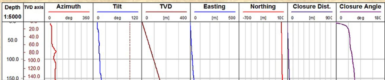
La sonda **QL40-DEV** viene impiegata per la valutazione della **deviazione dalla verticale** dei fori: la misura viene effettuata mediante utilizzo di appositi magnetometri ed accelerometri (sensore aps 544) installati all'interno della sonda in grado di rilevare inclinazione ed azimuth del foro. questi parametri sono calcolati e mostrati in tempo reale durante l'acquisizione.
