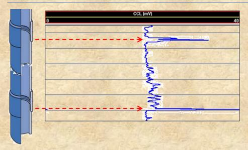
La sonda QL40-GR-CCL consente di effettuare misure di tipo "natural gamma ray" (GR) e "casing collar locator" (CCL). La parte gamma ray (GR) misura l'intensità della radiazione gamma proveniente naturalmente dal terreno attraversato dalla sonda mediante apposito sensore allo loduro di Sodio (Nal); essa è costituita principalmente dal contributo dovuto a Uranio, Torio e Potassio e fornisce informazioni essenziali sulla mineralogia e pertanto sulla lito-stratigrafia in esame.
