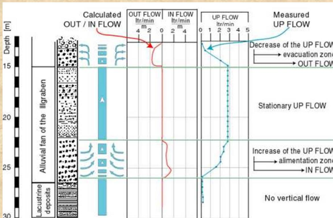
Log per la **misura della velocità di flusso del fluido all'interno del foro mediante misura della velocità di rotazione di un'elica**; consente di effettuare analisi idrogeologiche di estremo dettaglio finalizzate allo studio dell'idrodinamica sotterranea quali la misura effettiva della trasmissività di un acquifero, misure di alimentazione od assorbimento degli orizzonti acquiferi, identificazione di unità idrostratigrafiche, analisi delle potenzialità acquifere.
